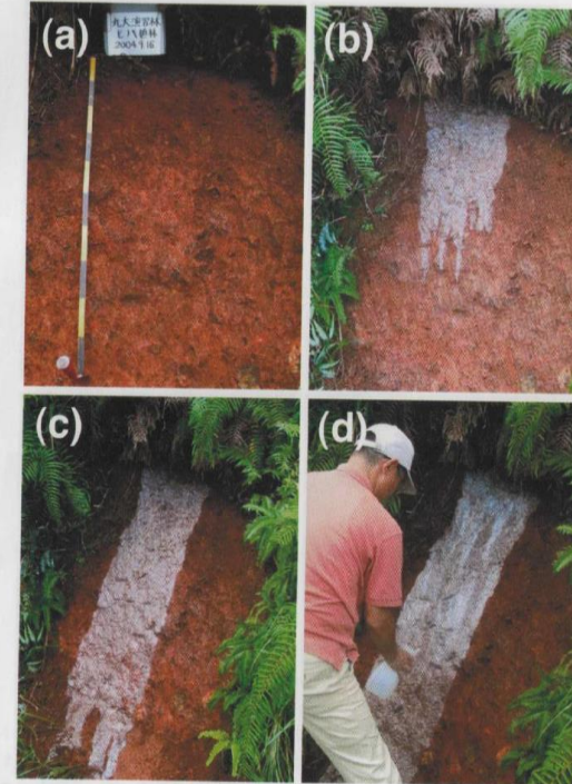
図 8.2 モノリス製作の詳細（その 1）：(a) 土壌断面の表面をできるだけ平らに整形する，(b) 接着剤の塗布（塗布するポイントは，土壌断面に角度を付けることに注意する。）(c) 接着剤を流す（流しすぎに注意する。）(d) 接着剤を流した土壌断面下部より，刷毛で土壌断面の表面に接着剤を塗布し，接着剤を固化させるために霧吹
